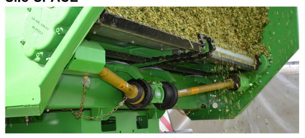
Es ist von nun an möglich, die Transportböden der Silagewagen Silo-SPACE über eine Kardanwelle und ein Verteilergetriebe mechanisch anzutreiben.
